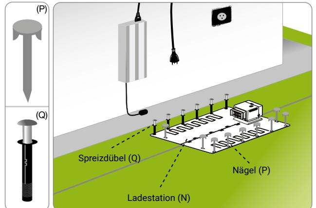
5. Installieren Sie das Netzgerät (A).
