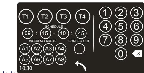
Für jede Arbeitszeit (T1,T2,T3,T4) die Anfangsuhzeit, die Enduhrzeit und die Bereiche einstellen, in denen der Roboter arbeiten kann.
