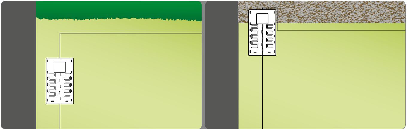
4. Fixieren Sie die Ladestation (N) am Boden mit den Nägeln (P). Falls erforderlich können sie die Ladestation mit Spreizdübeln (Q) befestigen.
